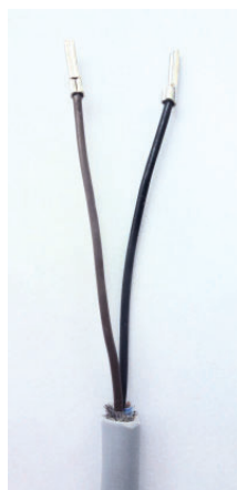
Przewody sensora napięciowego (Czarny / Brązowy)
